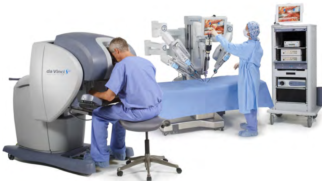
Figura 3.1: Exemplo de módulos que compõem o robô daVinci. Fonte: (KRAUS; KIBSGAARD, 2015).
